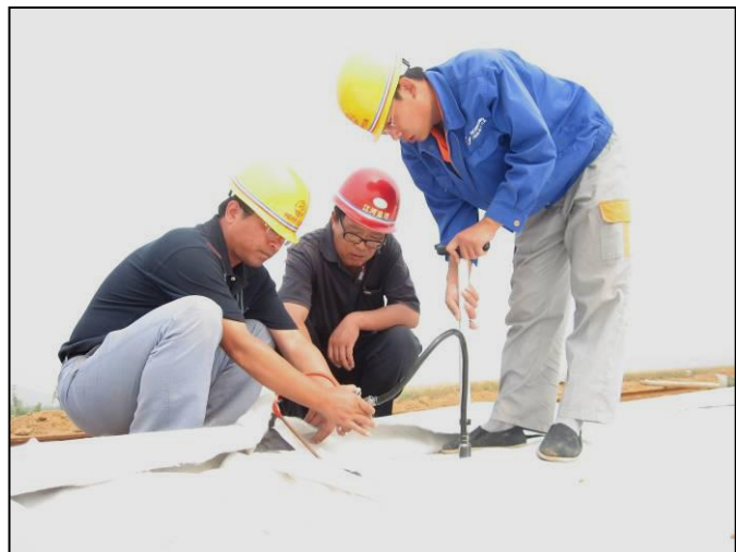
复合土工膜充气检验
