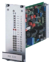
HE218 線性放大器 P-控制電流放大 電源: 18VAC(2) 輸入信號: 0...±10V 輸出信號: 0...±200 ±300/±400 ±650/±1000mA
