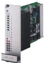
HE218 線性放大器 P-控制電流放大 電源: 18VAC(2) 輸入信號: 0...±10V 輸出信號: 0...±200 ±300/±400 ±650/±1000mA
