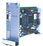
HE302 數位軸控制器 電源: +24VDC 類比輸入: 0...±5/10V (位置傳送LVDT) 數位輸入: 0/24V LED (軟體介面CNC-bus 12bit Plus 4bit parallel RS232) 數位輸出: 0/24V LED 伺服閥輸出: 0...±650mA
