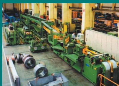
變壓器金屬薄片機械設備
